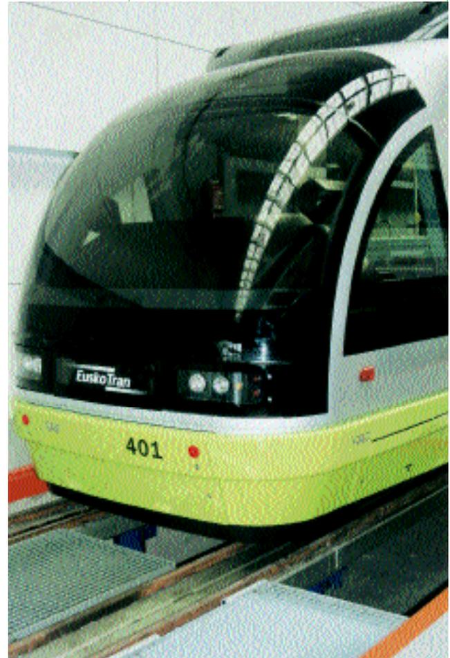
sistema nagusia elektrikoa da, eta osagarri ditu balazta hidrauliko bat bogie guztietan, eta labaindera elektromagnetikozko emergentziako balaztak bogie motordunetan. Zaratak eta dardarak gutxitzeko, gurpilak elastikoak dira.
